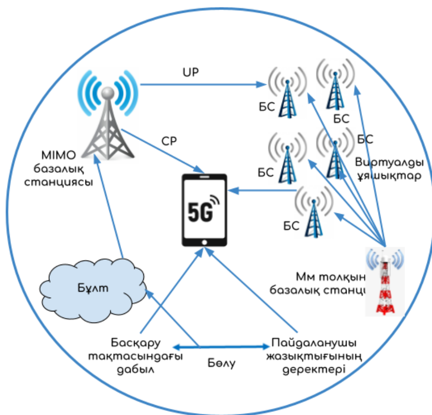
2.4-сурет – MIMO және миллиметрлік толқындағы байланыс технологияларын қолданатын 5G гетерогенді желілері
